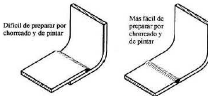
Figura 87.4.b Realización de soldaduras
